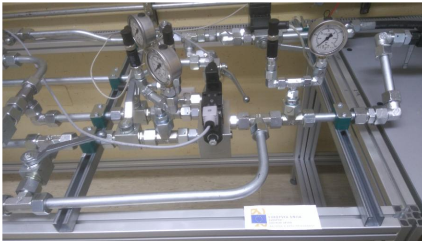
Slika 4: Detajl sklopa za merjenje statičnih karakteristik
