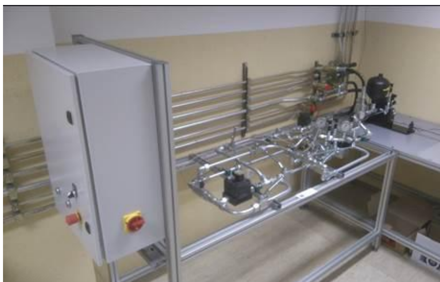
Slika 7: Celotni sklop za merjenje statičnih in dinamičnih karakteristik skupaj s pripadajočo krmilno omarico
